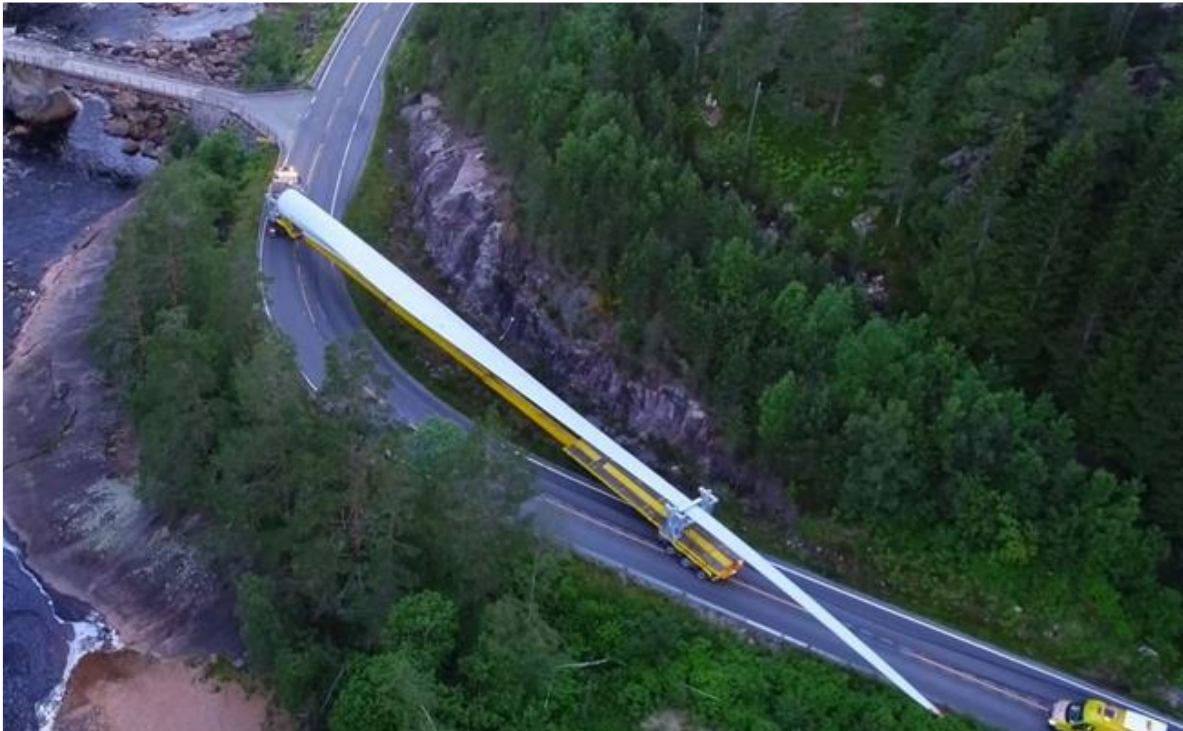
Figur 3-3: Transport av 70 meter lange turbinblader til Tonstad vindpark. Foto: Tonstad vindpark AS
