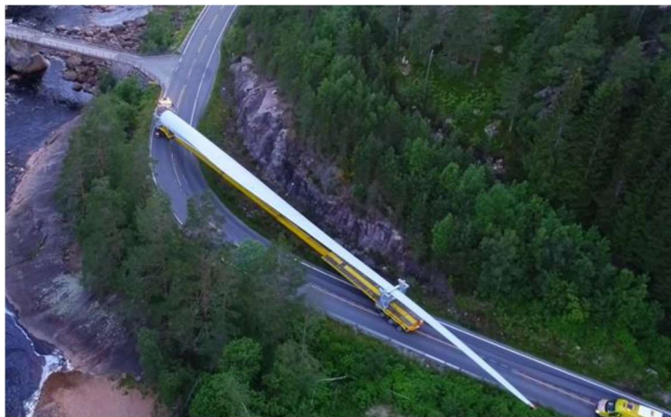
Figure 0-7: Transport av 70 meter lange turbinblader til Tonstad vindpark. Foto: Tonstad vindpark AS
