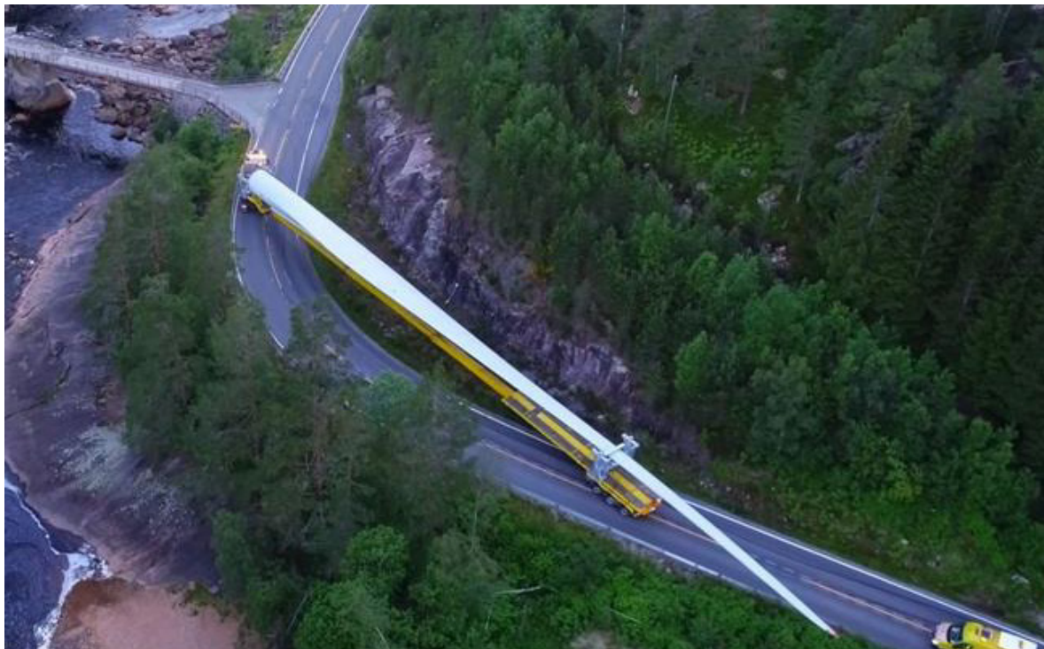
Figur 3-3: Transport av 70 meter lange turbinblader til Tonstad vindpark. Foto: Tonstad vindpark AS
